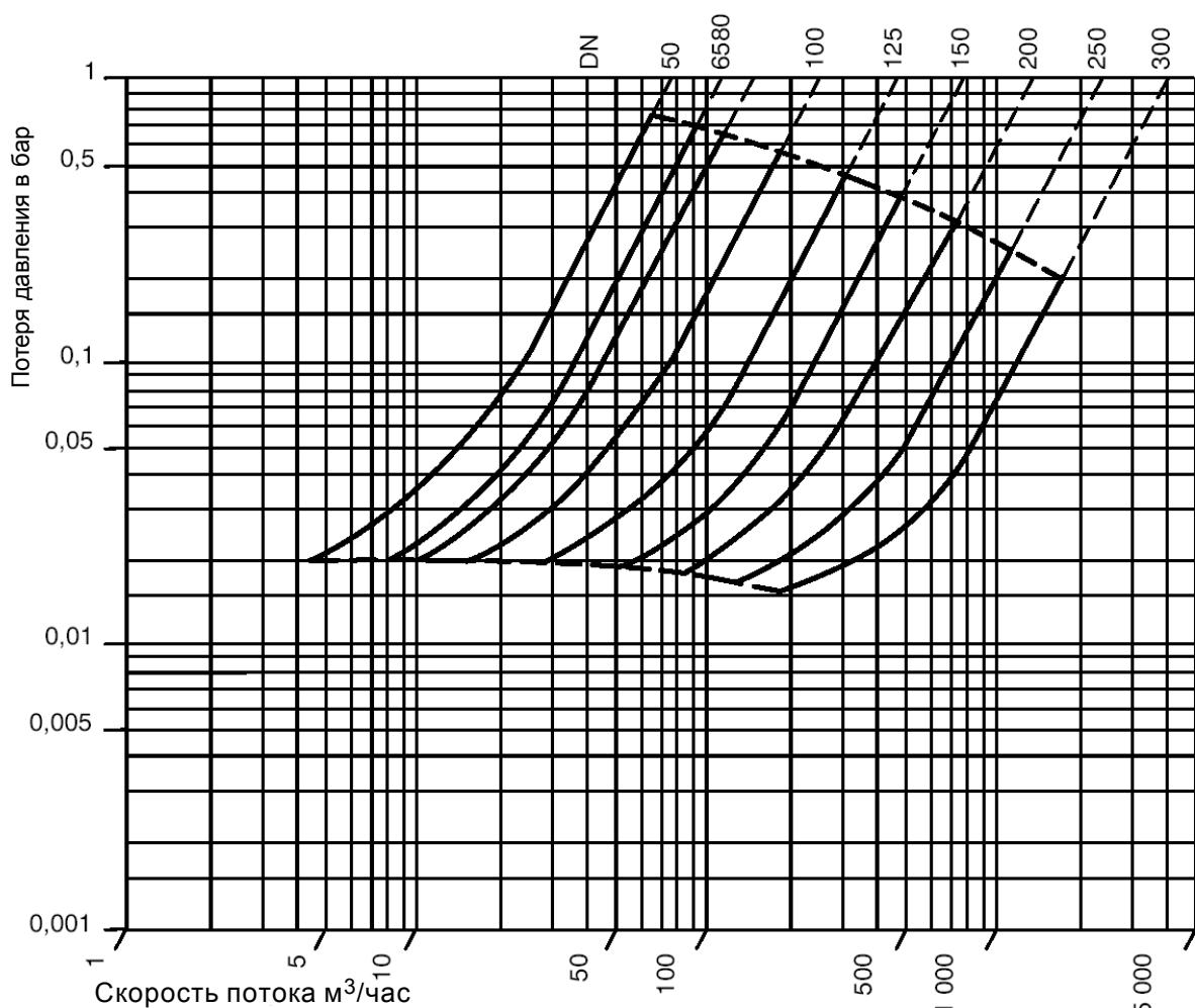
Характеристические кривые, представляющие из себя сплошные линии, определяют диапазон скорости потока, который является оптимальным при применении обратного клапана.
